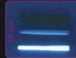
Koolstof, standaard glasvezel wortelstift en ENA POST glasvezel wortelstift (rechter afbeelding onder UV licht).
